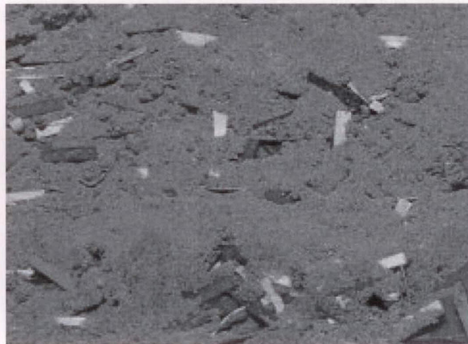
Rys. 11. Struktura przygotowanego fibrogruntu
