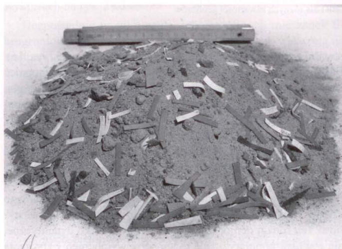
Rys. 11. Struktura przygotowanego fibrogruntu
