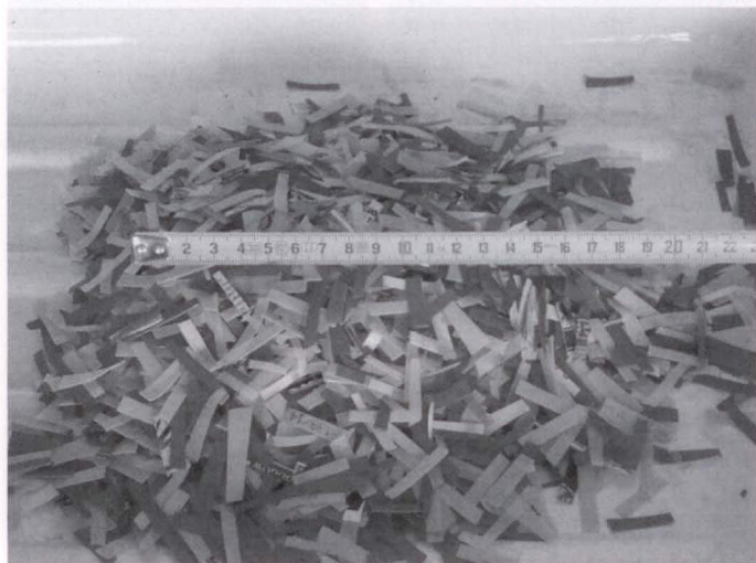
Rys. 10. Struktura i wymiary geofibrów
