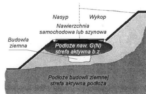
Rys. 2.1. Schemat podziału na części nasyp-wykop drogi lądowej w przekroju
