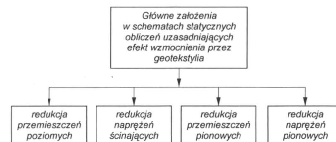
Rys. 3.18. Podział rodzaju założeń w schematach analogów obliczeniowych uzasadniających efekty wzmocnień stosowanych geotekstylii
