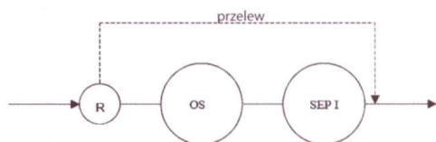
Rys. 6. Zakres autonomności odwodnienia równi stacyjnej
