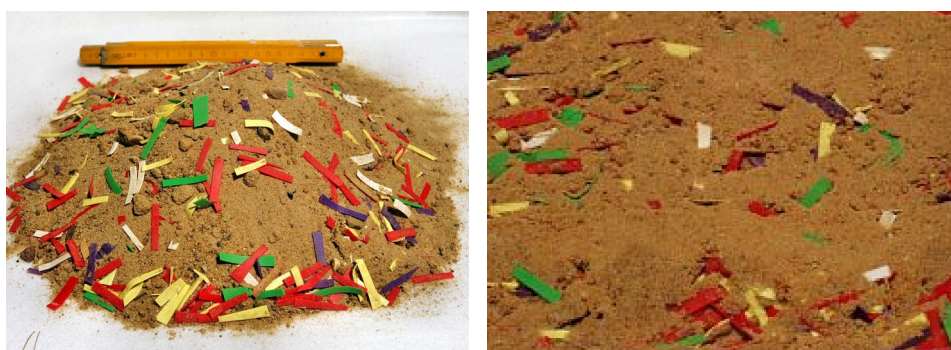
Rys. 6.15. Struktura przygotowanego fibrogruntu
