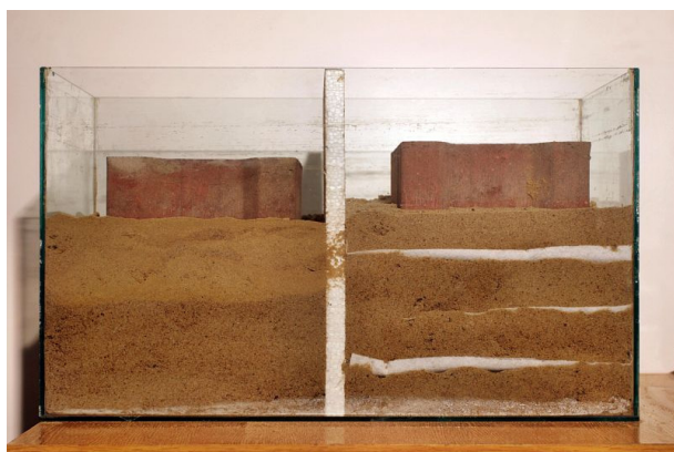
Rys. 7.1. Efekt kilkuwarstwowego zbrojenia geotekstylami w szklanym pojemniku
