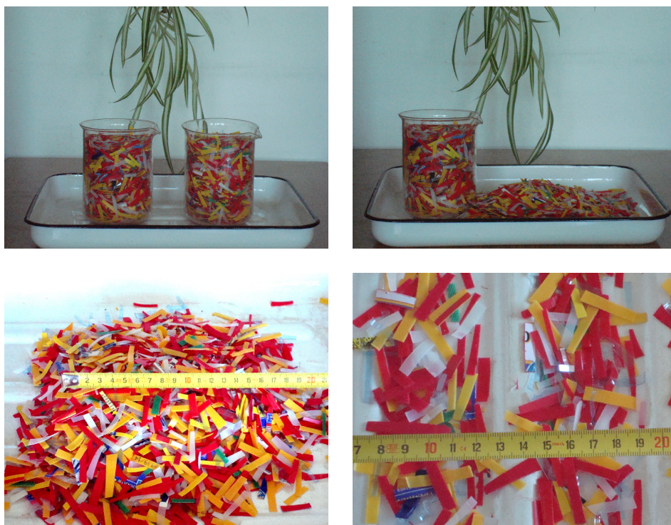
Rys. 6.14. Struktura i wymiary geofibr
