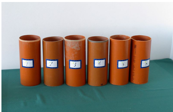
Rys. 4.4. Formy do badań edometrycznych próbek o różnych strukturach wypełnień uwarstwionych
