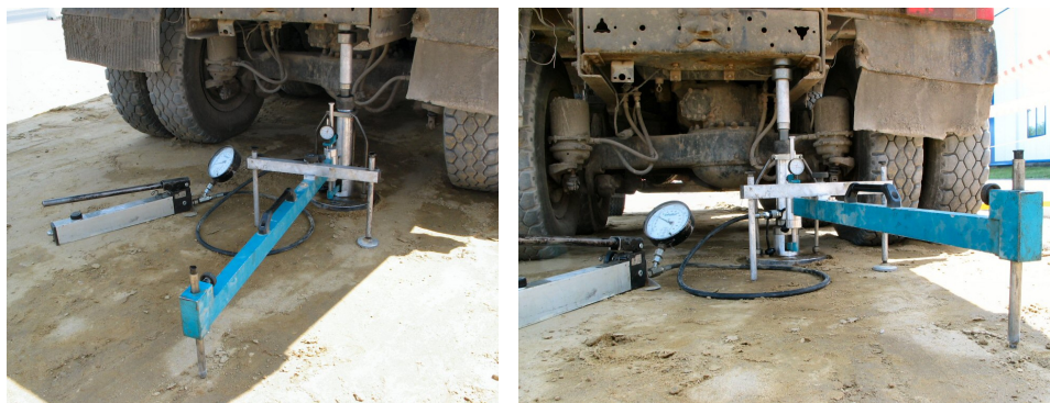
Rys. 5.5. Osprzęt do pomiaru modułów odkształcenia na poletku doświadczalnym
