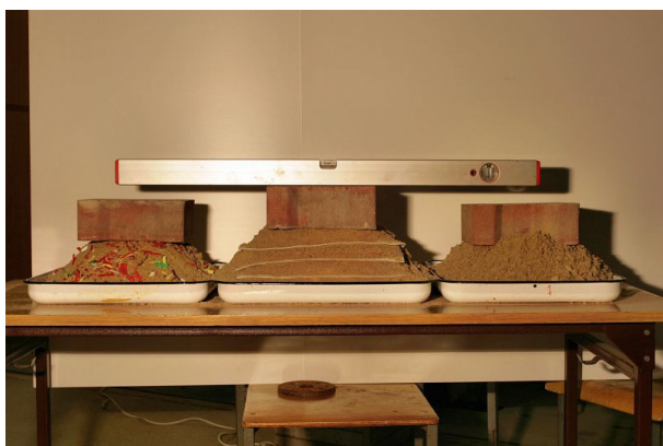
Rys. 7.6. Porównawcza demonstracja osiadań różnie zbrojonych podłoży
