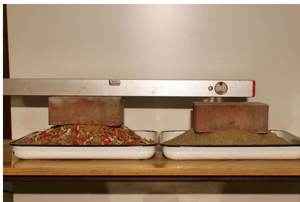
Rys. 7.3. Demonstracja mniejszej podatności fibrogruntów na osiadanie
