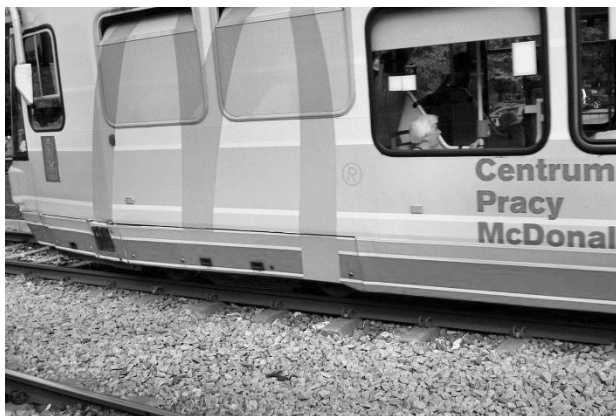
Fot. 2. Osłona podwozia tramwaju (fot. autor)
