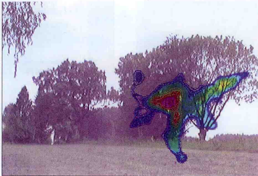
8. Obraz linii stałego natężenia dźwięku rozproszonego dla częstotliwości > 2000 Hz
